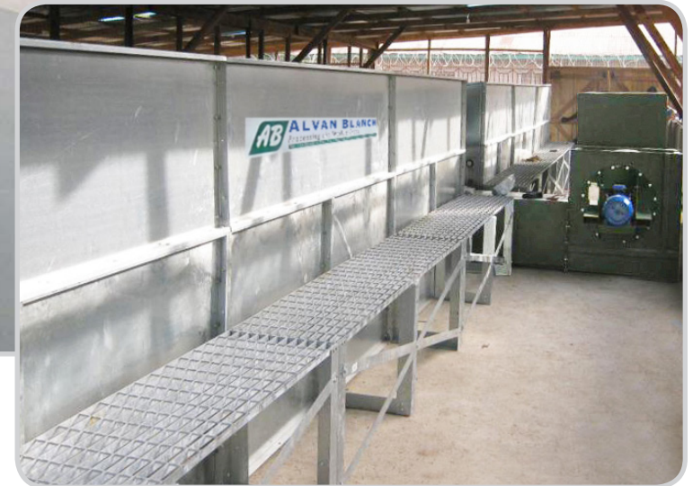
▼ Batch drier showing fan
